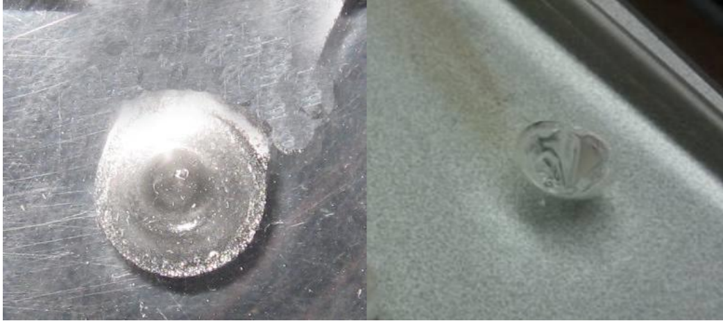
Ponto a laser com profundidade de 5 mm
