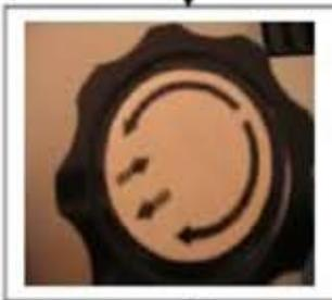
Rotação no sentido horário, reduz a profundidade de corte. Sentido anti-horário de rotação, adicionar a profundidade do corte.
