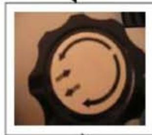
Rotação no sentido horário, reduz a profundidade das dobras. Sentido anti-horário, adicione a profundidade de dobras, o ajuste é 1mm / rotação.
